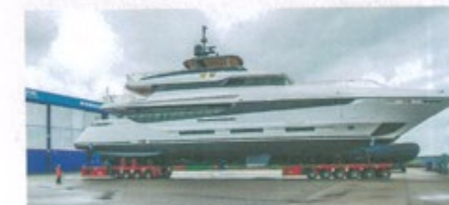
Mangusta Oceano 42: Das 42 Meter lange Alberto-Mancini-Design ist das erste auf weite Fahrt ausgelegte Verdränger-Format der Overmarine-Gruppe.
