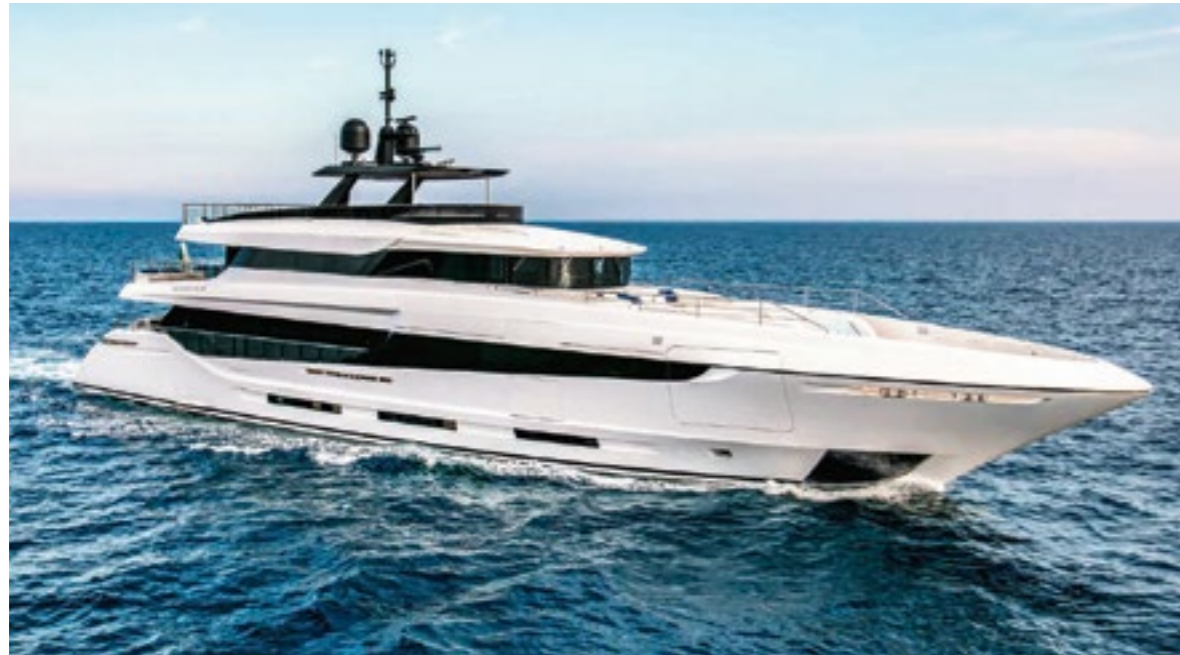
Sportliche Linien, geruhiges Tempo: Die Mangusta Oceano 42 erreicht mit ihren MTU-Dieseln (je 1080 kW) maximal 15 Knoten.
