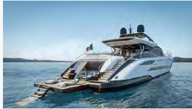
Mangusta 165 REV, dört adet MTU 16V 2000 dizel motorlarla donatılacak. Üretilen bu muazzam güç ile süperyat, 36 knot sürate erişebilecek.
