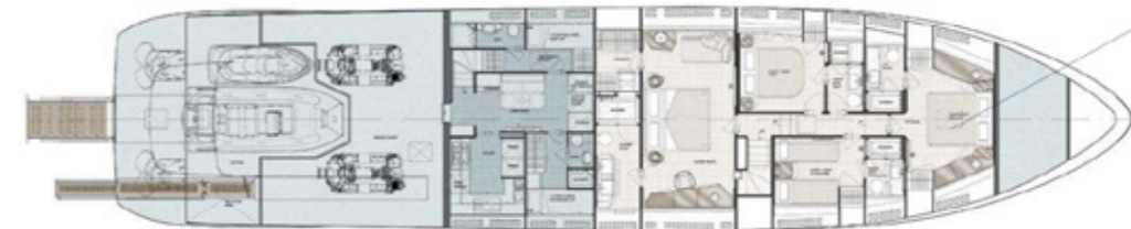
Unterdeck: Vor dem Motorenraum wohnt die Crew. Davor befinden sich die Eignersuite und drei Gästekabinen.
